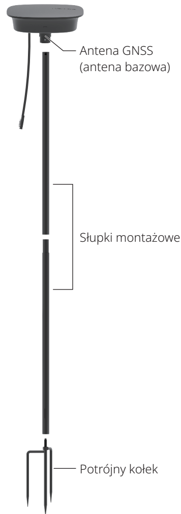
Stacja referencyjna RTK
