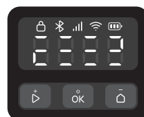
Sečení/Mapování/Návrat Čtyři číslice tvoří vzor, jak je znázorněno na obrázku. Každý segment vzoru se rozsvítí postupně. Jakmile se zobrazí celý vzor, sekvence se opakuje.
