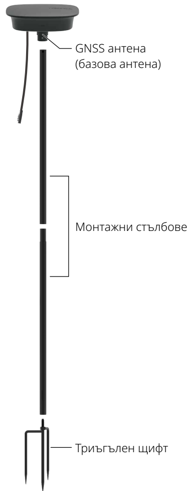
Референтна станция RTK
