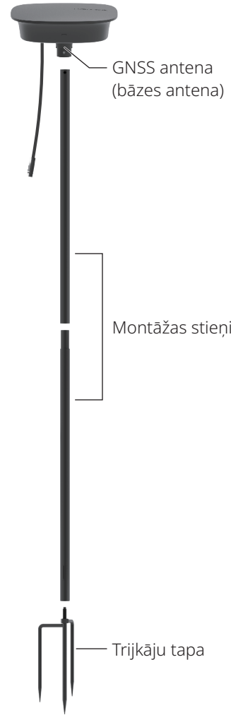
RTK bāzes stacija
