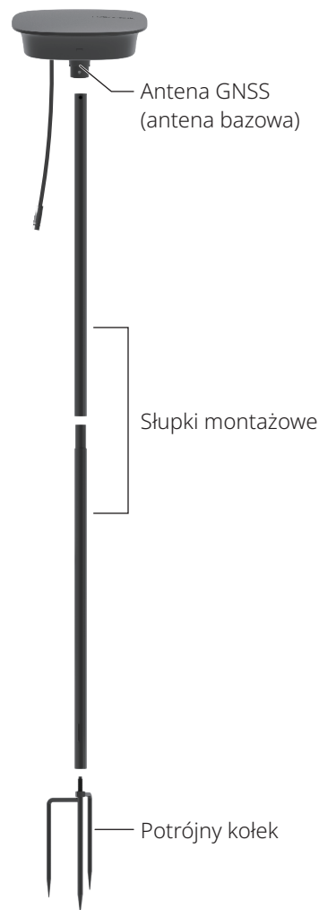
Stacja referencyjna RTK
