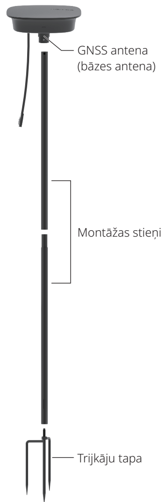
RTK bāzes stacija
