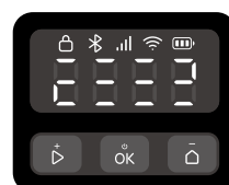
Koszenie/Wyznaczenie obszaru/Powrót Cztery cyfry tworzą wzór pokazany na ilustracji. Każdy segment wzoru zapala się sekwencyjnie. Po wyświetleniu pełnego wzoru sekwencja jest powtarzana.
