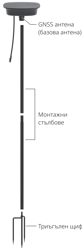
Референтна станция RTK
